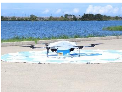
牛丼 4 個が入った箱を置き配する 物流専用ドローン AirTruck
